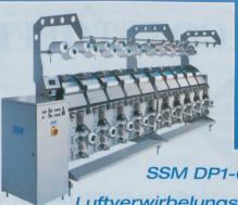
SSM DP1-C DIGICONE® preciflex™ Luftverwirbelungsmaschine
