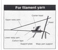
Abb. 6: Neue Greiferführung bei Toyoda
