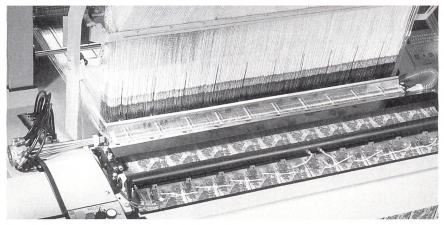
Bild 1: Die Luftdüsenwebmaschine MÜJET für Etiketten
