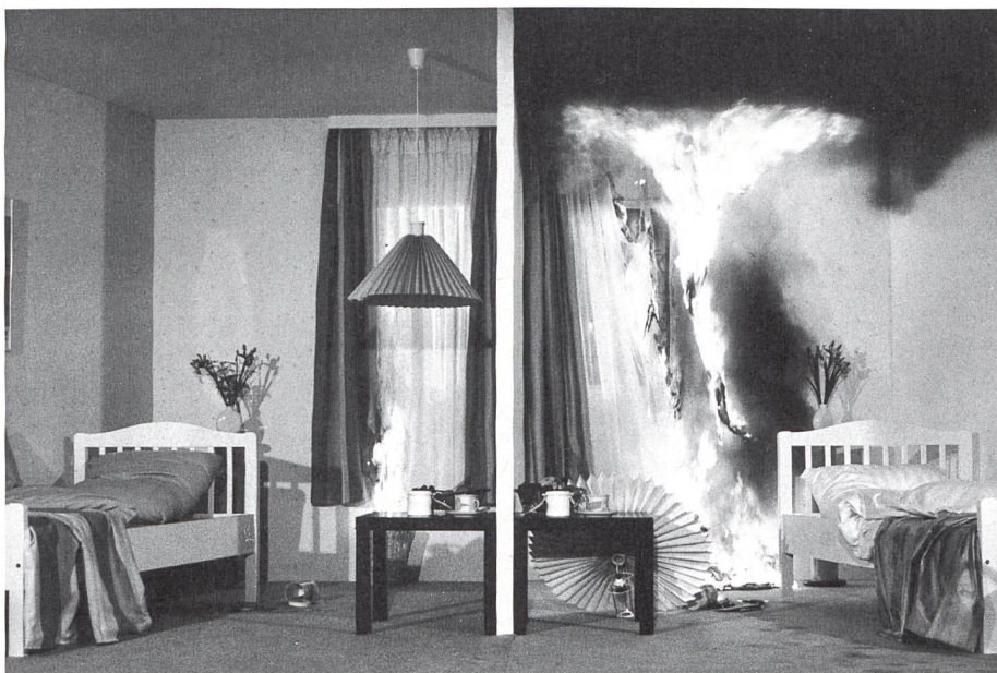
Vergleich von zwei Zimmern. Zimmer rechts, Einrichtung mit Heimtextilien ohne flammhemmende Ausrüstung. Zimmer links mit Heimtextilien aus Trevira CS. Nach gleicher Branddauer ist die unterschiedliche Brandausbreitung bereits gut zu erkennen.
