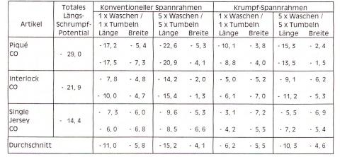
Tabelle 2: Schrumpfwerte in % verschiedener Artikel, offen breit ausgerüstet, auf konventionellem Spannrahmen und auf Krumpf-Spannrahmen
