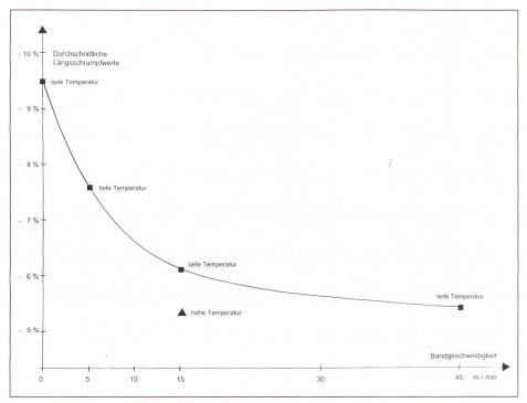
Figur 5: Einfluss von Bandgeschwindigkeit und Temperatur
