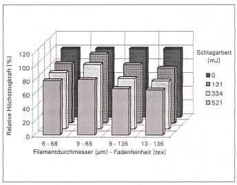
Bild 12: Einfluss der Filamentfeinheit bei gleicher Fadenfeinheit auf den Schädigungsgrad; Prallplatte Piacryl, Schlagelement 1/1
