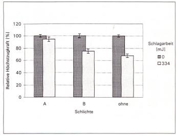
Bild 10: Einfluss der Schlichte auf den Schädigungsgrad; Garnfeinheit 68 tex, Prallplatte Piacryl, Schlagelement 1/1
