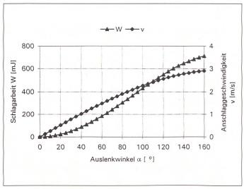
Bild 3: Schlagarbeit und Anschlaggeschwindigkeit abhängig vom Auslenkwinkel
