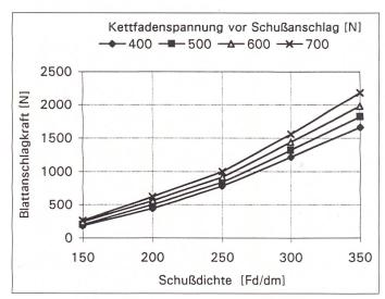
Bild 2: Einfluss der Schussdichte auf die Blattanschlagkraft nach [10]
