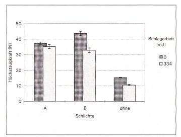
Bild 11: Einfluss der Schlichte auf den Abfall der feinheitsbezogenen Höchstzugkraft; Garnfeinheit 68 tex, Prallplatte Piacryl, Schlagelement 1/1
