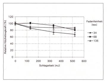
Bild 8: Einfluss der Garnfeinheit auf den Schädigungsgrad; Filamentfeinheit 9 Arm Prallplatte Piacryl, Schlagelement 1/1
