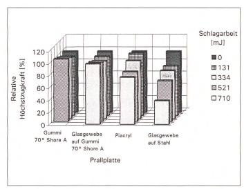
Bild 6: Einfluss der Prallplatte auf den Festigkeitsverlust eines Glasfilamentgarnes;
