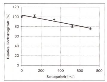
Bild 5: Einfluss der Schlagarbeit auf die Schädigung eines Glasfilamentgarnes;
