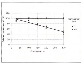
Bild 9: Einfluss der Garndrehung auf den Schädigungsgrad; Garnfeinheit 68 tex, Prallplatte Piacryl, Schlagelement 1/1
