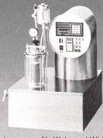
HT Färbeapparat für Web- und Wirkware, Garn, Strang und Flocke, Flottenumwälzung mittels Zahnradpumpe, Durchflussrichtung reversierbar, Optionen wie Regelsystem für Durchfluss und Differenzdruck, Dosieren, Flottenentnahme, pH-Steuerung
