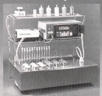
Turby mit programmierbarer Dosierstation Multidos, 12 HT-Becher 300 ml kurze Flottenverhältnisse Flottenzirkulation aussen/innen mittels Magnet-Rührer, Aluminiumheizblock
