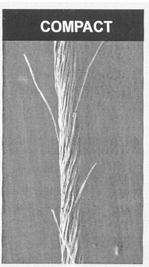
Vergleich der Garnstruktur zwischen einem herkömmlichen Ringspinn- und einem Compact-Garn
