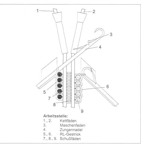
Schema des biaxial verstärkten Mehrlagengestrickes
