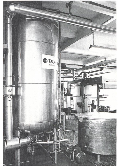
Der Oxidationsreaktor – Kernstück des neuen Konzeptes für die Abwasseraufbereitung
