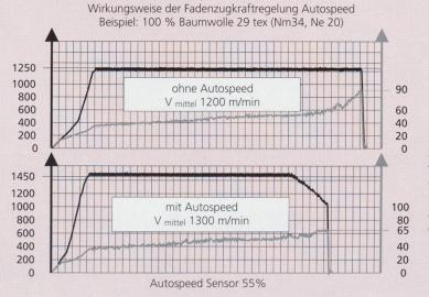
**D**ie Autospeed-Regelung gewährleistet beim Autoconer System 238:
