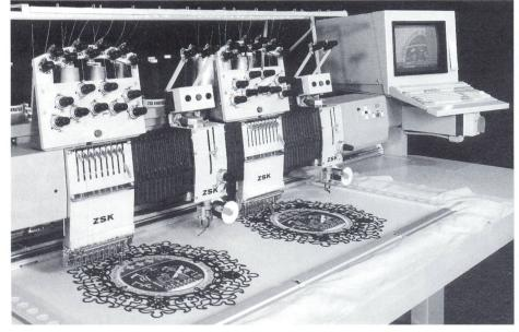
ZSK Sondermaschine JCC, 2-Kopf-Kombinationsmaschine
