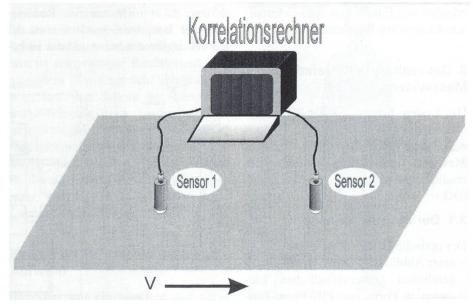
Abb. 1: Geschwindigkeitsmessung nach dem Korrelationsprinzip
