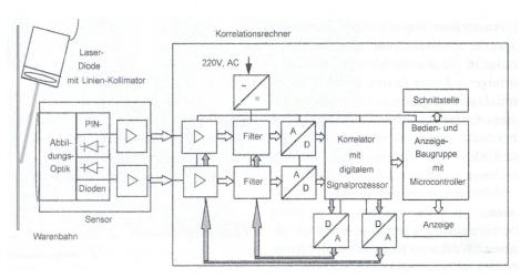
Abb. 3: Sensor mit Auswerteschaltung
