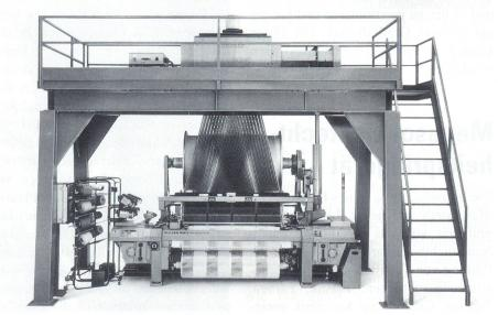
Greiferwebmaschine G6200 in der Frottierversion
