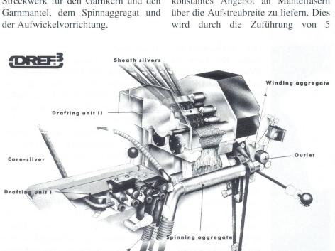
Bild 2: Spinnprinzip DREF3
