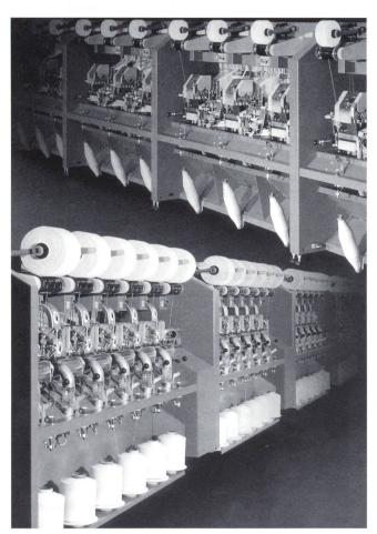
Bild 1: DREF3/96-Friktionspinnmaschine für den mittleren Garnbereich (oben)
