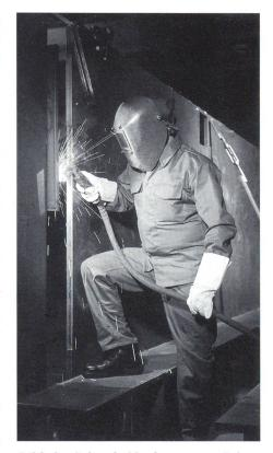
Bild 3: Schutzbekleidung zum Schutz vor Metallspritzern aus DREF3-Garn
