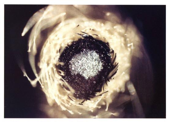
Bild 5: Schnitt eines DREF3-Garnes: Glasfilament und Karbonfasern im Kern, ummantelt mit Kevlarstapelfasern für das Einsatzgebiet Feuerblocker
