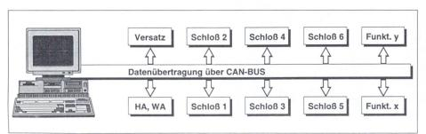
Datenübertragung mittels CAN-Bus
