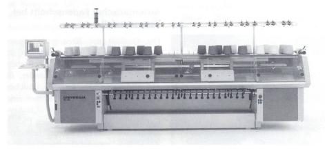
Computergesteuerter Doppelkopf-Flachstrickautomat MC-868
