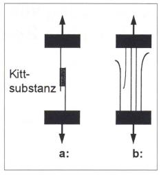
Bild 2 : Probleme bei der Zugmessung von Faserbündeln
