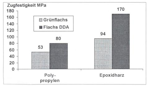
Bild 7: Zugfestigkeit von Flachsfaservliesen
