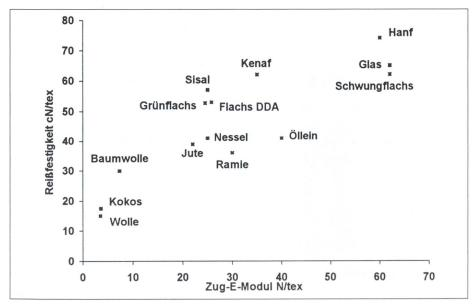
Bild 3: Reissfestigkeit gegen Zug-E-Modul (auf 0 mm Einspannlänge extrapoliert)
