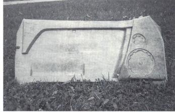
Bild 5: Verrottbare Formteile aus Flachs
