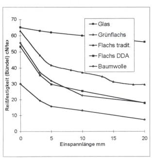
Bild 1: Reissfestigkeit in Abhängigkeit der Einspannlänge: Vergleich Glas-Naturfaser
