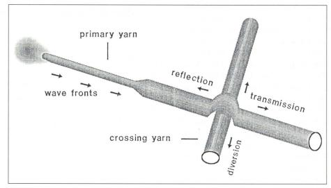
Abb. 1: Schockwellenfortpflanzung im Gewebe nach einer ballistischen Einwirkung
