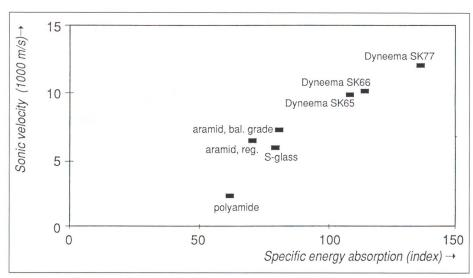
Abb. 2: Ballistisches Potential von Fasern
