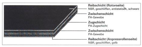
Bild 1: Struktur des Open-End-Riemens SOE-250 für Rotorspinnmaschinen
