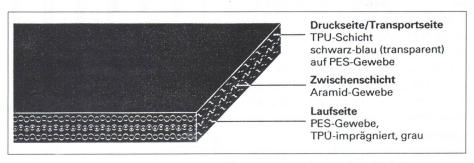
Bild 3: Struktur der Druckdecke EAU-50A mit Aramid-Gewebeschicht
