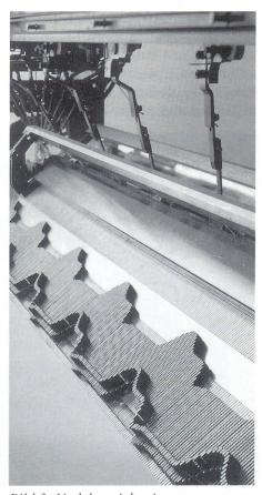
Bild 3: Nadelantrieb mit Linearmotoren Foto: Tsudakoma
