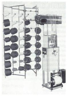
Bild 6: Rundkettenwirkmaschine Mod. PA 8 Foto: Harry Lucas
