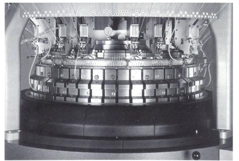
Bild 4: OVJA 0.8ER mit elektronischer Jacquardauswahl, Maschenübertragung und Ringelapparat Foto: Mayer & Cie.
