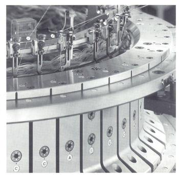
Bild 5: Jacquard-Farbplüsch mit Vollreihen-Technologie Foto: Terrot
