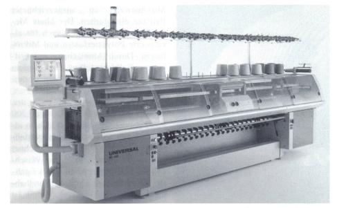
Computergesteuerter Flachstrickautomat MC-830
