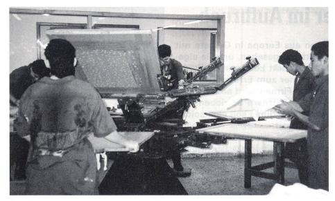
Bild 3: Manuelles Bedrucken von T-Shirts am Handdrucktisch
