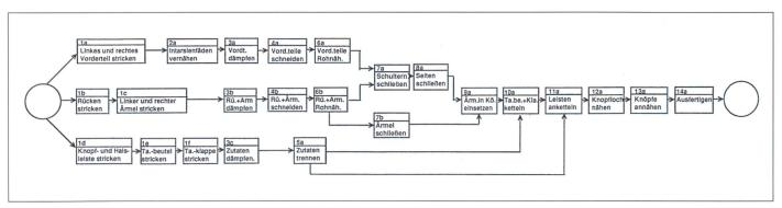
Bild 3: Netzplan mit 24 Arbeitsgängen (herkömmliches Fertigungsverfahren)
