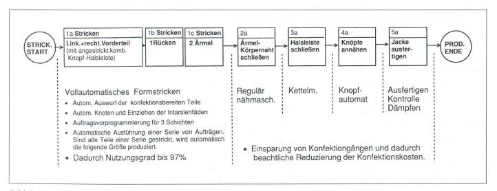
Bild 4: Netzplan für Damenjacke mit 7 Arbeitsgängen durch Lean making Up.
