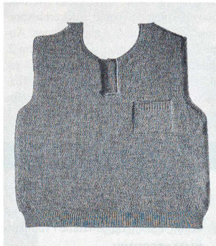
Bild 1: Formgestricktes Vorderteil mit regulärem Halsausschnitt und eingearbeitetem Übertritt
