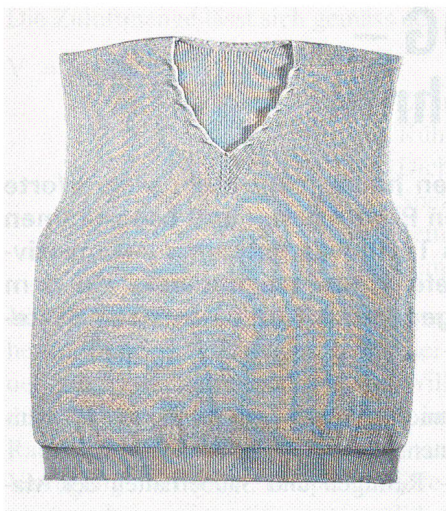
Bild 2: Formgestrickter Komplett-Körper mit eingestrickter Halseinfassung
