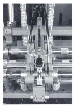
Streckwerk für das Compactspinnen auf einer Rieter Ringspinnmaschine G 30 Foto: Rieter
