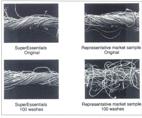
Schädigung des Baumwollgarnes durch Wash-and-Wear-Beanspruchung
