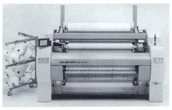
Die Reihenfachwebmaschine M8300 von Sulzer Rüti Foto: Sulzer Rüti
