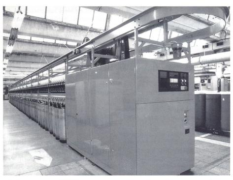
OE-Spinnmaschine BT 905
