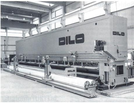
Nadelmaschine, Typ DI-LOOM OD-I (P) 154
