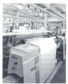
Luftdüsenwebmaschine Delta Foto: Picanol
