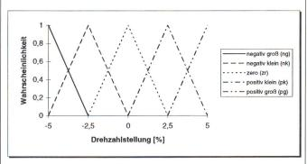
Abbildung 3: Zugehörigkeitsfunktion für die Drehzahlveränderung
