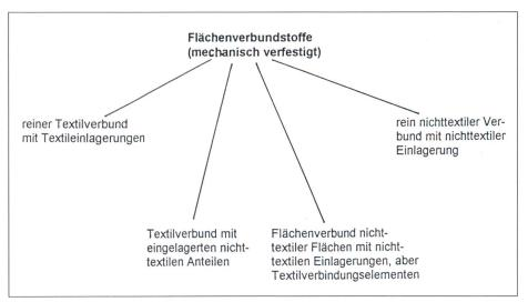
Abb. 1: Aufbauvarianten mechanisch verfestigter Verbundstoffe
