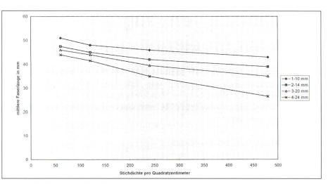
Abb. 4: Einfluss der Stichdichte und Einstichtiefe auf die mittlere Faserlänge
