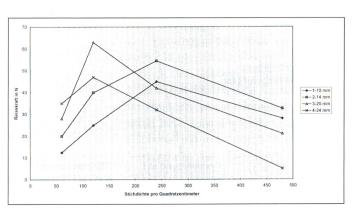
Abb. 6: Zusammenhang zwischen Reisskraft des Vliesstoffes, Stichdichte und Einstichtiefe
