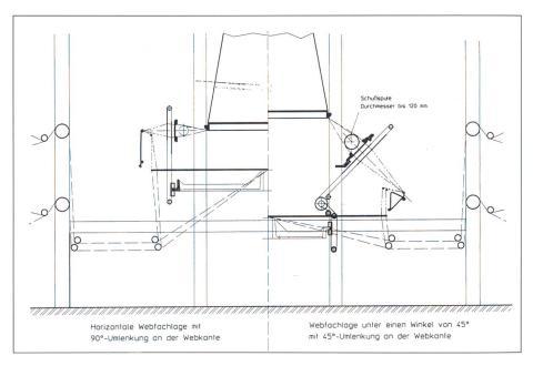
Abb. 2: Gegenüberstellung der Kändler-«Circular loom» (45-Grad-Webfach) zu traditionellen Rundwebmaschinen (horizontales Webfach)
