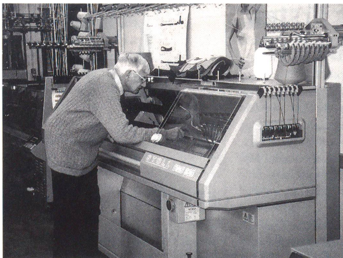
Fachlehrer Fritz Benz beim Einstellen des elektronisch gesteuerten Flachstrickautomaten CMS 330
