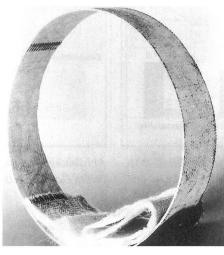
Rohrsanierung mit Composites aus Glasfaser-Malimo-Nähgewirken Foto: Malimo Maschinenbau
