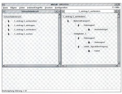
Abbildung 2: Bildoberfläche in der Entwicklungsumgebung, links: Störung (Schussfadenbruch)-> gestörte Funktionen, rechts: Funktionsstörungsbaum der Funktion «Schuss verhindern»
