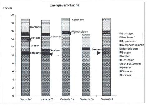
Abb.: A Darstellung Energiebedarf Herstellung Webtextilie Anmerkungen:
