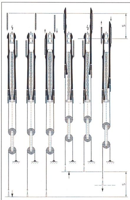
Bild 2: Funktionsprinzip des Systems EJP-2
