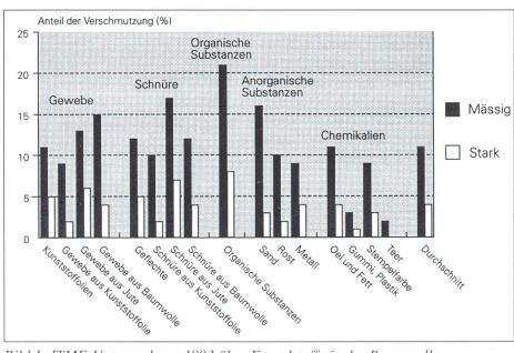
Bild 1: ITMF-Untersuchung 1993 über Fremdstoffe in der Baumwolle
