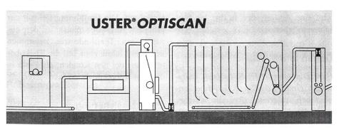
Bild 5: Anordnung von USTER® OPTISCAN nach dem Mischer in der Putzerei
