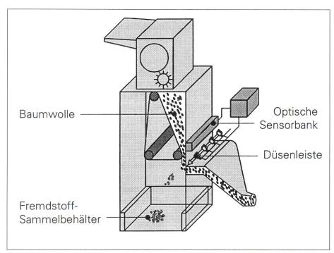
Bild 2: Funktionsprinzip USTER® OPTISCAN
