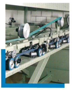
Prüfstand für Tangentialriemen
