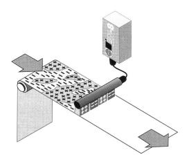
Statische Aufladungen führen in vielen Fertigungsprozessen zu Störungen. HAUG-lonisationssysteme lösen dieses Problem bei der Folien- und Papierverarbeitung sowie in der Textil- und Kunststoffindustrie.
