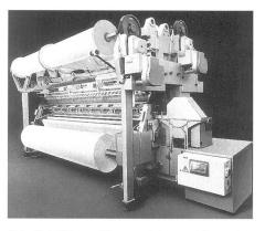
Die Jubiläums-Kettenwirkmaschine, eine Elastik-Raschelmaschine RSE 4 N-2
