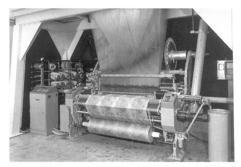
Dornier-Greiferwebmaschine, Typ HS mit 190 cm Nennbreite
