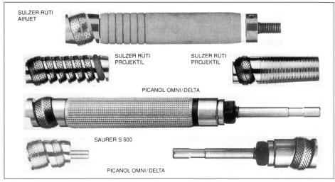
Bild 3: Conterschon-Anordnungen bei verschiedenen Webmaschinentypen
