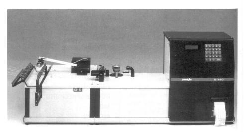
Bild 1: Zweigle Garnstrukturtester
