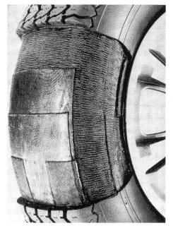
Bild 1: Querschnitt eines Reifens
