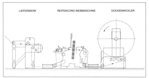
Bild 2: Grob-Aggregate für automatisches Reifencord-Weben
