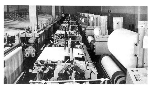
Bild 3: Reifencord-Aggregate auf Sulzer-Rüti-Projektil-Webmaschinen
