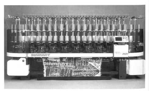
Bild 1: Flachstrickautomat FRJ 2000
