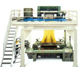
zendrell usw. erfordern modernste Technik in der Weberei. Bei der Greiferwebmaschine G 6200 sorgt eine serielle Schnittstelle für die Kommunikation mit der Jacquardmaschine. Daraus resultiert ein Höchstmass an Flexibilität.
