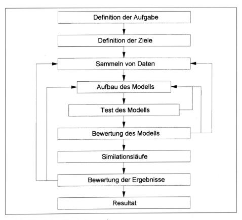
Bild 1: Ablauf einer Simulationsstudie
