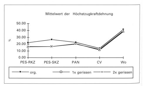
Abb. 3: Mittelwerte der Höchstzugkraftdehnung
