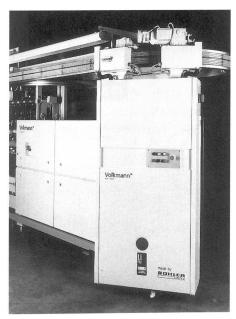
Volkmann-Zwirnmaschine mit VOL-COCLEAN von Sohler Airtex
