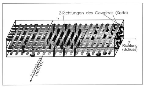
Bild 2: 3D-Gewebeband: Prinzipskizze der Weborientierungen, Fadenlagen
