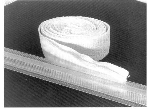
Bild 3: Biegebalken aus 3D-Glasfaser-Gewebe-Band mit Epoxi-Matrix
