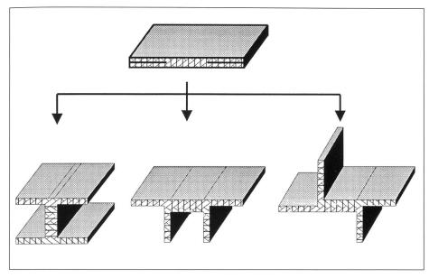
Bild 1: Mögliche Faserverbund-Profilquerschnitte aus einem 3D-Gewebeband
