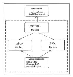
Abb. 2: Struktur des CONTROL-Master
