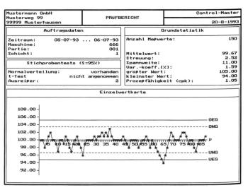
Abb. 5: Prüfbericht
