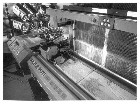
Bild 2: Frottierwebmaschine mit der dynamischen Florsteuerung
