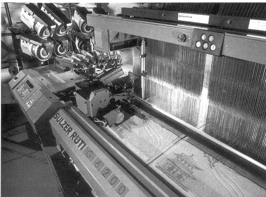
Bild 2: Frottierversion Jacquard mit der dynamischen Florsteuerung Foto: Sulzer-Rüti
