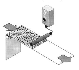
Durch die Beseitigung statischer Elektrizität bei der Verarbeitung von Textilien optimieren Sie den Produktionsablauf und senken die Kosten.
