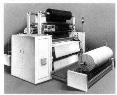
Nähwirkmaschine Malimo, Typ Multiknit
