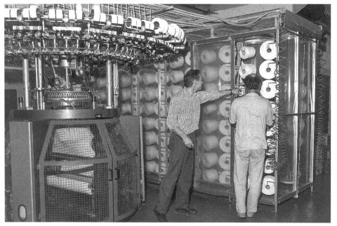
Rundstrickmaschine mit Cleanknit-Gatte
